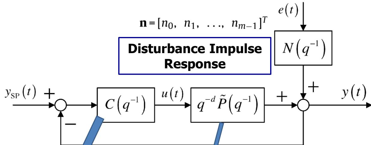
$$C_{PID}(q^{-1}) = \frac{c_1 + c_2 q^{-1} + c_3 q^{-2}}{1 - q^{-1}}$$
